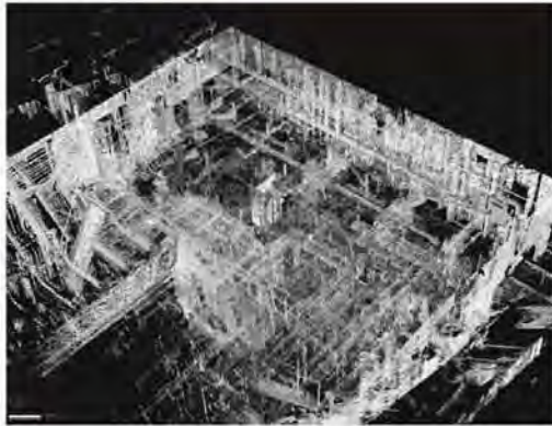
用 3D 激光扫描仪测得的机舱点阵数据
