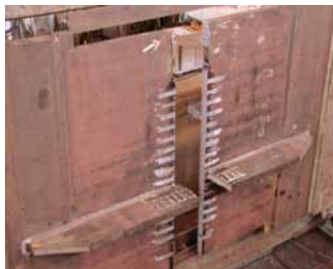
Крупномасштабные испытания по хрупким трещинам
