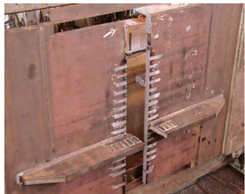
扩大结构模型脆性断裂试验
