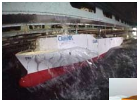
上：大型集装箱船冲荡反应的拖曳水池测试
